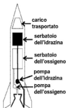
*Figura 2.1 – Schema di endoreattore a bipropellenti*
